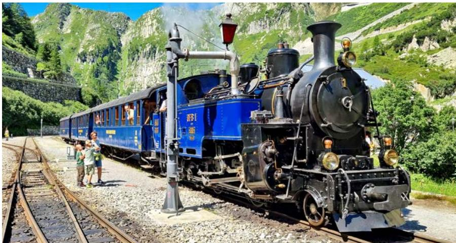
Sie braucht Kohle: Die Lokomotive 1 der Dampfbahn Furka-Bergstrecke, hier beim Wasserfassen in Gletsch. Bild: Lorenz Degen
