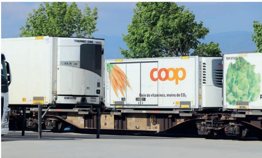
Wechselbrücke von RailCare.
