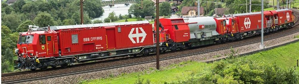
Die Einheit Lösch- und Rettungszug ist 4 teilig und wird ergänzt um einen Hilfswagen. Der Basiszug
