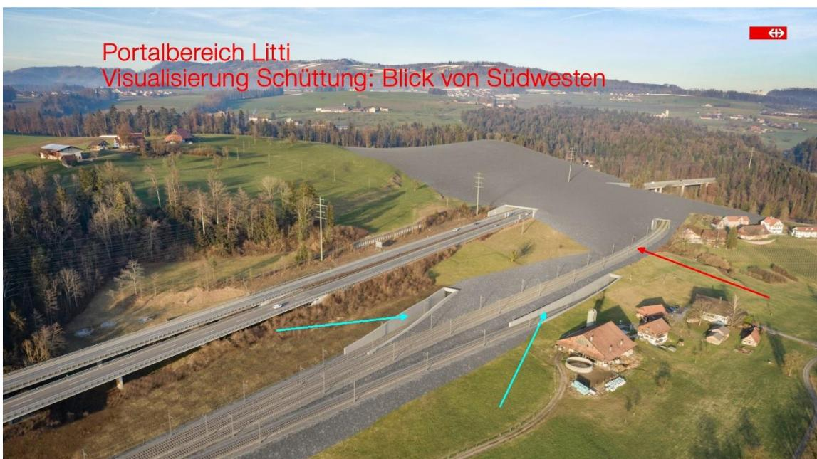
Dies ist eine – frühe - Visualisierung der «Geländemodellierung» mit dem Tunnelaushubmaterial. Der rote Pfeil bezeichnet die Bestandesstrecke, die beiden blauen Pfeile die Tunnelportale des ZBT II. Der aktuelle Stand der Modellierung ist uns nicht bekannt.
